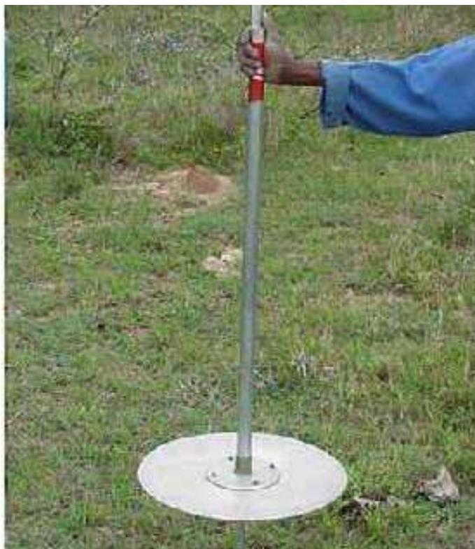
**Figura 32- Disco medidor de pastagem**
