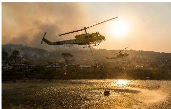
Figura 41- Helicópteros UH1 enchendo baldes Bambi de água do mar para a extinção de incêndio
