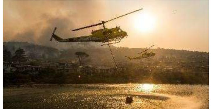
Figure 41- Des hélicoptères UH1 remplissant des seaux Bambi en mer pour l'extinction des incendies.
